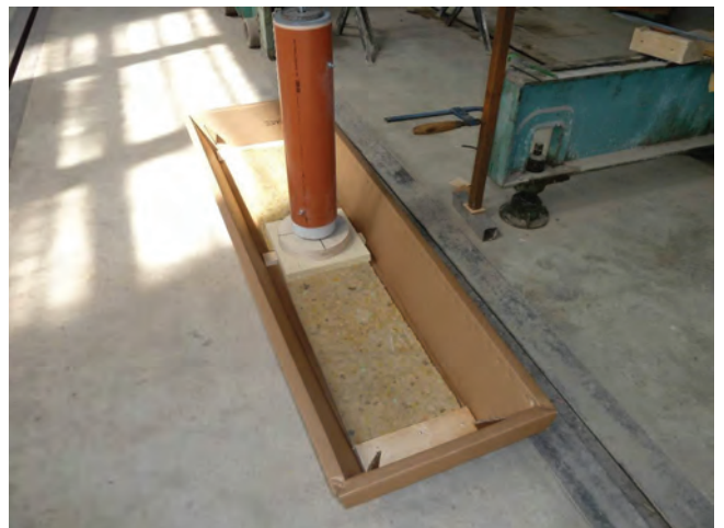
Obr. 3: Dynamická zkouška spodního dílu papírové rakve
