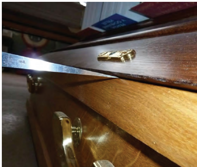
Obr. 5: Měření spáry po zkoušce
