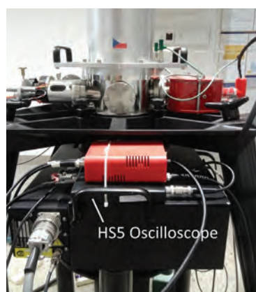
Obr. 2: Nahoře: Schéma vyhodnocovacích systémů státního etalonu. Původní i nový systém pracuje se signálem ze stejné fotodiody (50 MHz APD). Původní systém určuje průchody nulou pomocí TTL komparátoru a nový systém digitalizuje analogový signál pomocí osciloskopu HS5 a průchody nulou jsou určeny pomocí FFT. Vlevo dole: Nový vyhodnocovací systém umístěn na interferometru FG5-215. Vpravo dole: Interferometr s novým optickým izolátorem a \lambda/2 destičkou.
