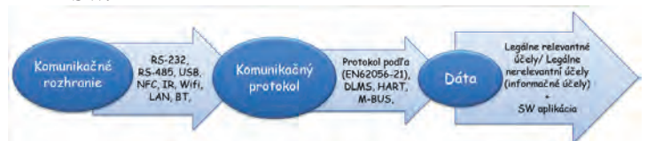
Obr. 4: Štruktúra komunikácie pre prenos nameraných údajov
