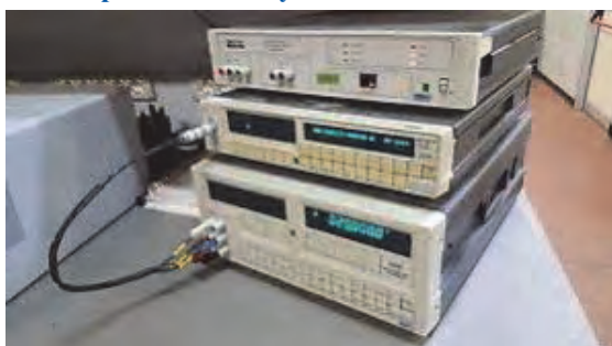
Obr. 11: Multimetr by nikdy neměl ležet na kalibrátoru, aby nebyl ovlivněn zvýšením teploty vlivem teploty unikající z kalibrátoru
