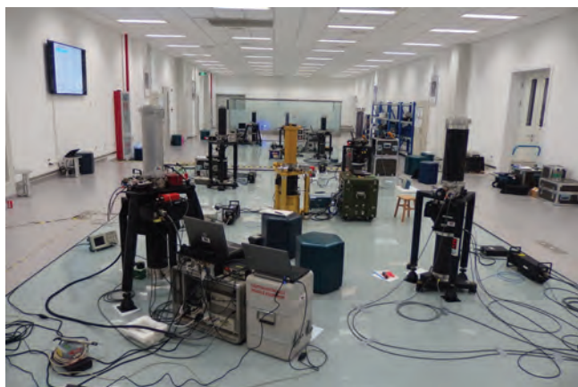
Obr. 6: Hlavní místnost nové gravimetrické laboratoře v Changping kampusu NIM, místo klíčového porovnání absolutních gravimetrů v roce 2017. V popředí je vidět první pilíř s pěti absolutními gravimetry a v pozadí pilíř druhý, který je výškově o 0,4 m níže. V zadní části místnosti je za prosklenou stěnou umístěn relativní supravodivý gravimetr a čtyři relativní pružinové gravimetry.
