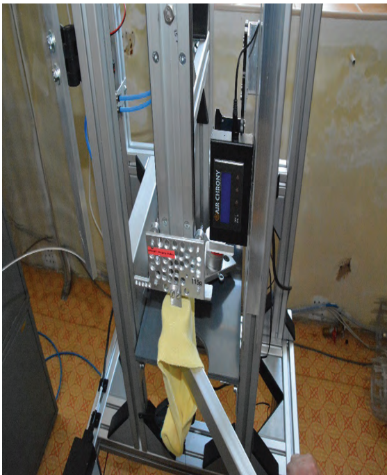
Obr. 3: ČSN EN 1082-3 Ochranné oděvy - Rukavice a chrániče horních končetin chránící proti říznutí a bodnutí ručními noži - Část 3: Zkouška nárazovým řezem pro textilie, usně a jiné materiály
