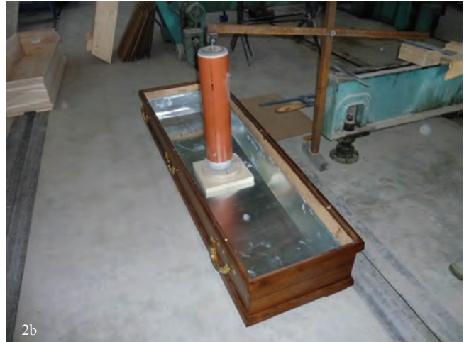
Obr. 2a, b: Dynamická zkouška spodního dílu rakve
